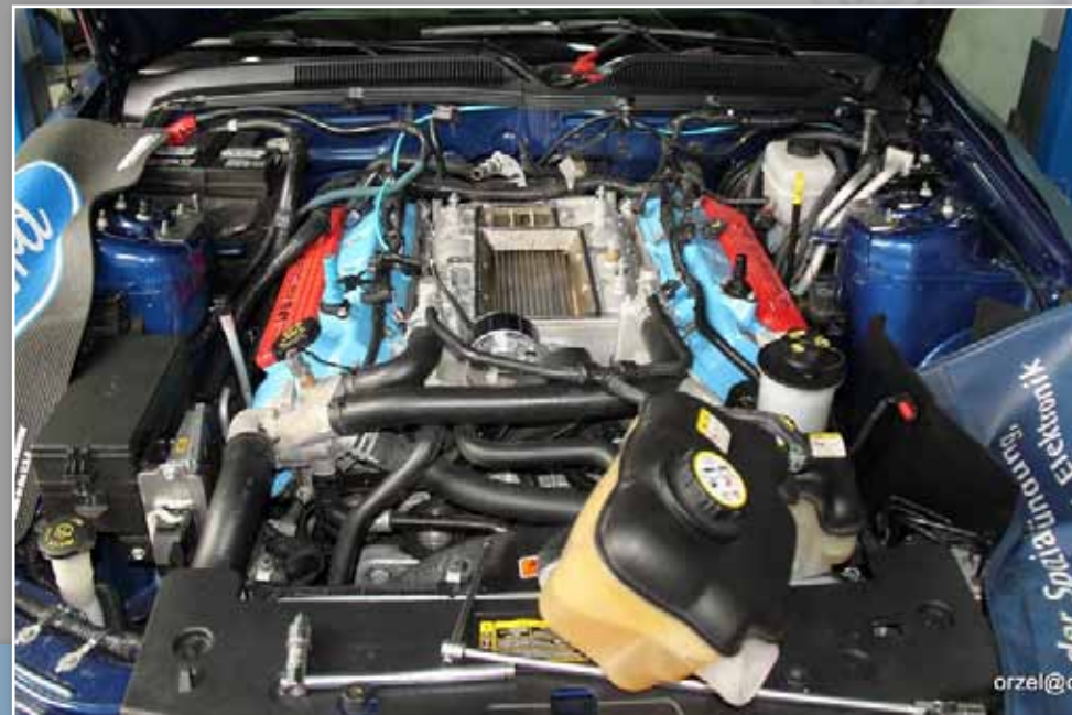
Fabryka adrenaliny. Supercharger Kenne Bell skutecznie wspomaga jednostkę napadową. Silnik dobrze znosi doładowanie i generuje w nim moc 732 KM.
