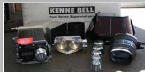
Fabryka adrenaliny. Supercharger Kenne Bell skutecznie wspomaga jednostkę napadową. Silnik dobrze znosi doładowanie i generuje w nim moc 732 KM.
