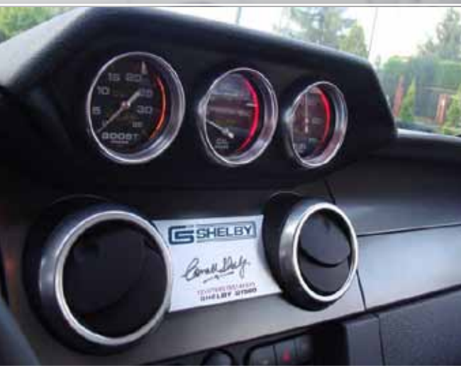
Wskaźniki ciśnienia doładowania kompresora, oleju i paliwa. W środkowej części plakietka typu „nieśmiertelnik” z wygrawerowanym numerem VIN i własnoręcznym podpisem samego mistrza - Carrolla Shelby
