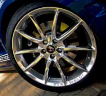
Tarcze 14" i gigantyczne zaciski zatrzymają nawet pociąg.
