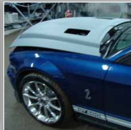
Potężny wlot powietrza na masce to techniczna konieczność. Pod pokrywą silnika znalazł się agregat o pojemności 5,4 litra
